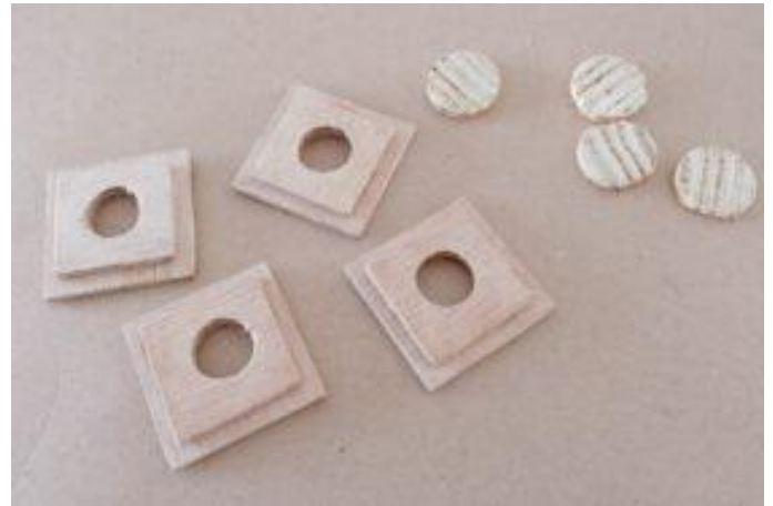
Zelf creatief afwerkplaatjes gemaakt zodat de bouten niet meer zichtbaar zijn
